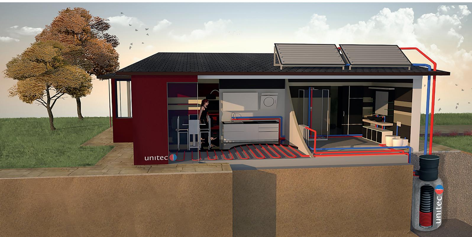
Solarthermieanlage für kombinierte Warmwasserbereitung und Heizungsunterstützung.
