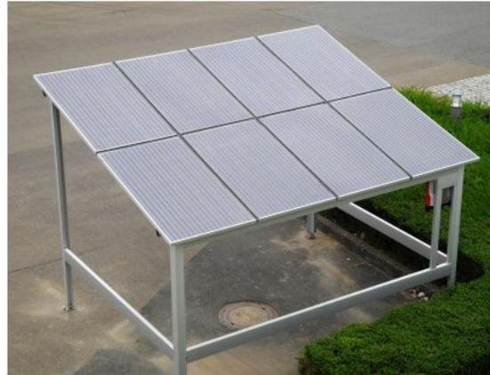
Die Unterkonstruktion besteht aus silberfarbenem, eloxiertem Aluminium. Auf Wunsch sind andere Eloxalfarben / Pulverbeschichtungen erhältlich. Alle verwendeten Schrauben sind aus Edelstahl und somit rostfrei. Mit den verwendeten Glasdicken von 2 x 3 mm haben die Solarmodule eine außergewöhnlich hohe Stabilität gegenüber dem Glas-Folien-Modul in rahmenloser Ausführung, dadurch entfallen Staukanten.
