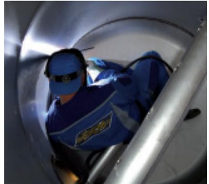
Auch Edelstahl Wassererwärmer, mit und ohne Wärmetauscher, können auf diese Art und Weise ausgearbeitet und gefertigt werden.
